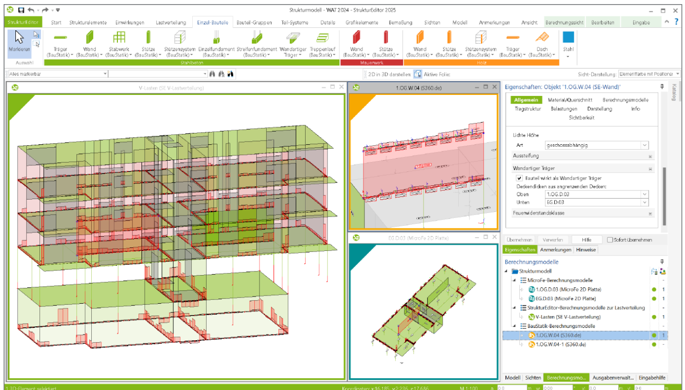
Bild 1. Strukturmodell mit wandartigem Träger und Eigenschaften (rechts)
