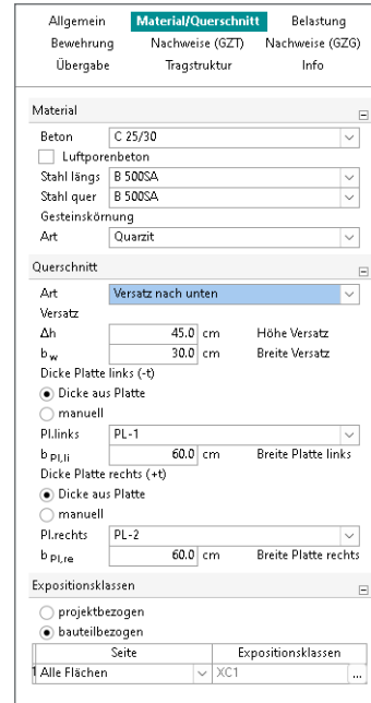
Bild 4. Querschnittseingaben des Deckenversatzes
