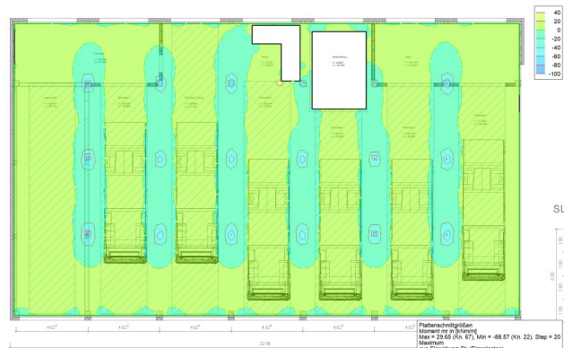
Bild 9. Schnittgrößen-Ergebnisse des Deckensystems
