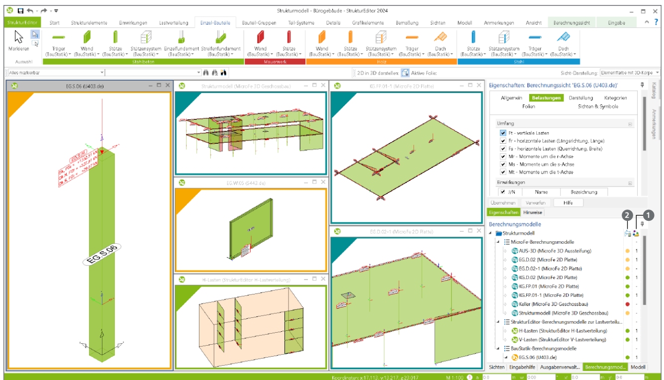
Bild 1. StrukturEditor-Modell mit verschiedenen Berechnungsmodellen
