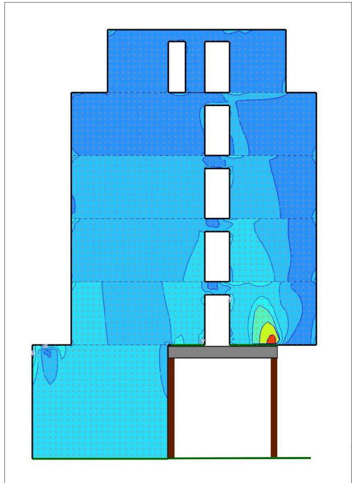
Bild 5. Walden 48 - Spannungsausnutzung der auskragenden BSPH-Wandschotte in MicroFe (©ifb)
