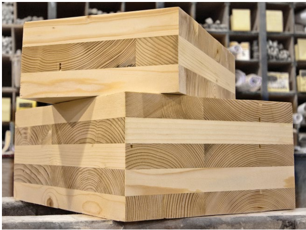
Bild 1. Drei- und fünfplagige Brettsperrholzbauteile [9] Foto: Oregon Department of Forestry, CC BY 2.0, flickr
