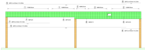
Bild 9. Bewehrungsverlegungen sind eingeblendet
