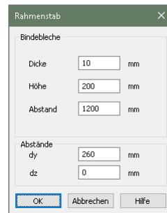
Bild 2. Rahmenstab-Parameter in den Stahlstab-Positionseigenschaften
