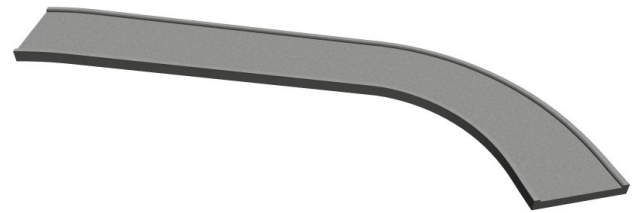
Bild 8. Zufahrtsrampe mit Ausrundungen und Quermeigung
