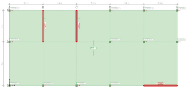
Bild 4. Wand-Bauteile in der Draufsicht (z-Richtung)
