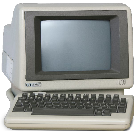
Der Original-Computer, auf dem MicroFe entstand. Mit sagenhaften 9 inch Bildiagonale, einer 400 mal 300 Pixel Auflösung und einer Speicherkapazität von 128K RAM.
